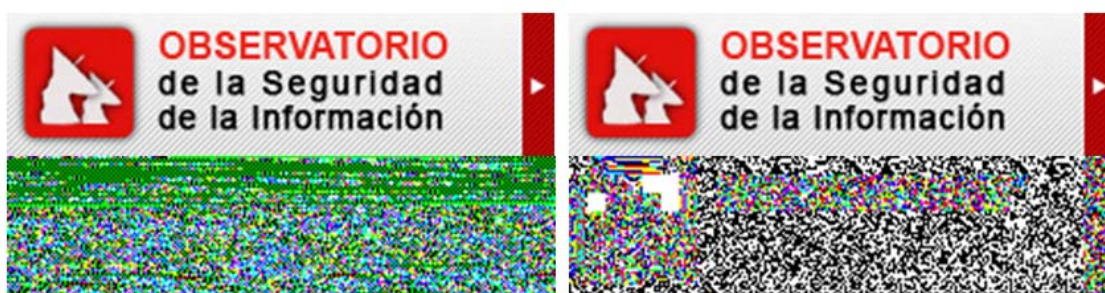
Ilustración 7: Estegoanálisis manual de un BMP con información oculta mediante LSB
