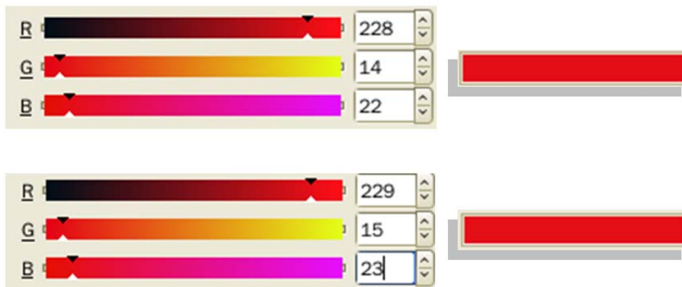
Ilustración 4: Efecto visual de la modificación de los bits menos significativos de las componentes RGB de un píxel
